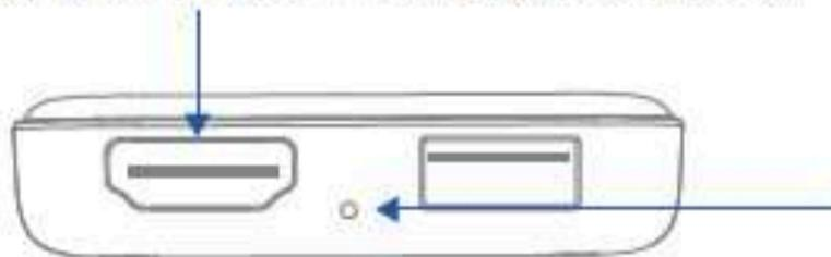
(本製品が動作しなくなったり、誤動作を起こした際は、伸ばしたクリップの先端等、先の細い物で押し、再起動してください。)
